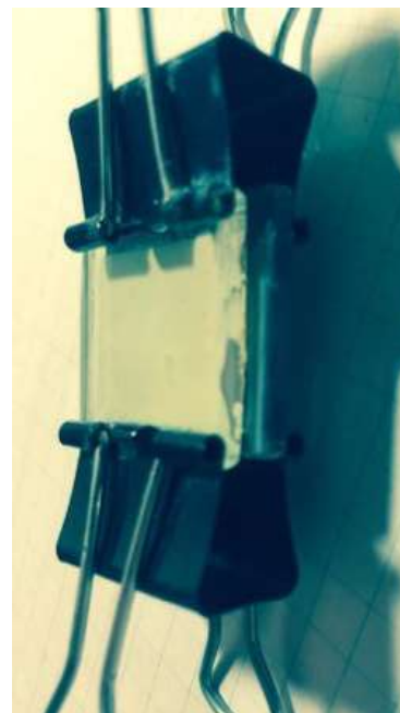
Figure 2: Schéma de l'assemblage des deux verres d'une cellule avec les deux agrafes.
